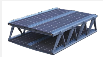
狮子洋过江通道双层桥面板
