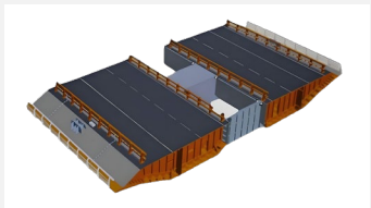
西堠门大桥开槽箱梁
